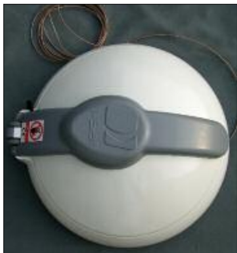
A destra, il particolare illuminatore della i-Sat. Sopra, il cavo coassiale RG 179 che facilita notevolmente l'installazione.
