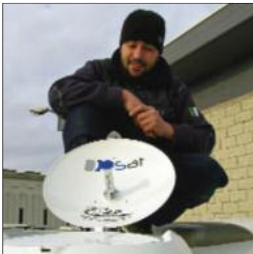
A sinistra, il facile smontaggio dell'unità dalla sua base. Sotto, una volta terminata l'installazione si verifica il corretto funzionamento dell'antenna sintonizzando un canale televisivo.
